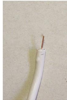
Puis insérez le câble dans la prise après l'avoir ouverte (clips). La languette du mécanisme doit se glisser entre l'isolant du câble et le blindage tressé.
